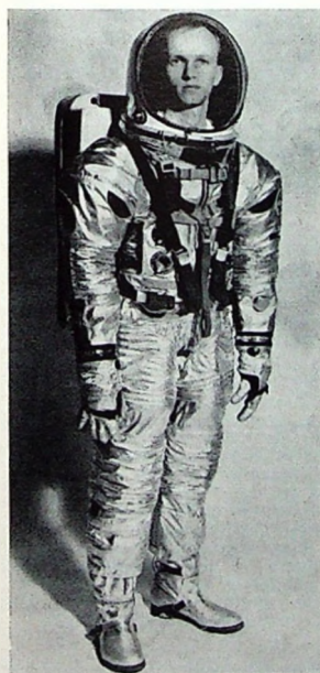
Bild 9. Die neueste Version der Apollo-Raumanzüge mit dem auf dem Rücken befindlichen „Lebenserhaltungssystem“, das dem Astronauten den Aufenthalt auf der atmosphärenlosen Mondoberfläche ermöglicht; gleichzeitig sorgt es für entsprechende Temperaturen im Inneren des Raumanzuges
